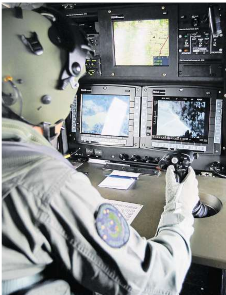
Lucek an seinem Arbeitsplatz im Super Puma: Links das Bild der Videokamera, rechts dasjenige der Infrarotkamera und darüber die Karte mit der Position des Helikopters.
